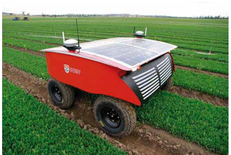
RIPPA, o "Robot per a la Percepció Intel·ligent i Aplicació de Precisió", que ha estat desenvolupat pel professor Sukkarieh i el seu equip per a aplicacions agrícoles. Foto cortesia de la Universitat de Sydney.
