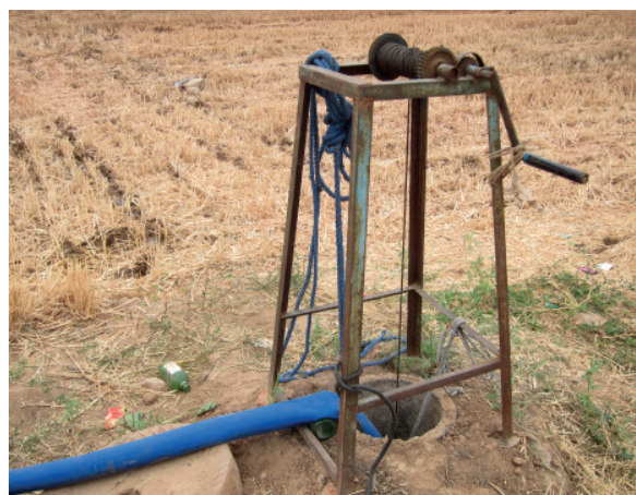
Bomba submergible d'aigües subterrànies per al reg explotació d'aqüífers subterranis al comtat de Guantao [Pedrazzini 2015]
